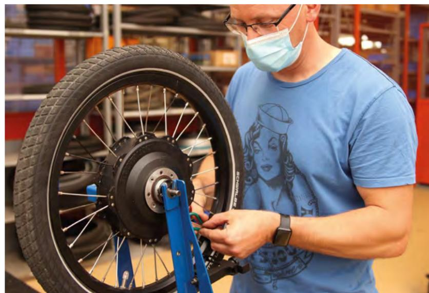
**In der Fahrradwerkstatt werden vor allem Radnaben-Motoren in Lastenräder von Kunden eingespeicht.**
